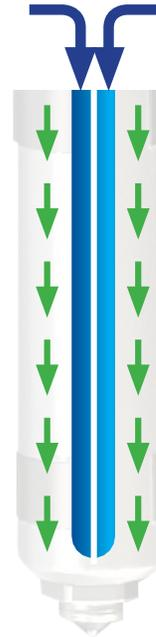
1) Schmelze wird von **mehreren Seiten** in die Düse geführt.
