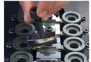
**SCHRITT 2** Gebraucher Schmelzblock herausziehen.
